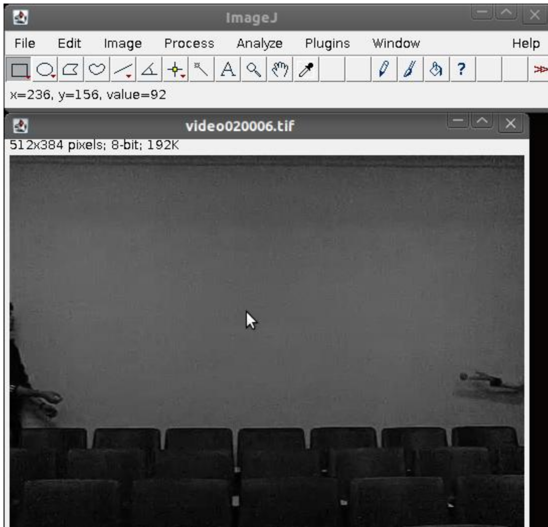
Figura 9. Cuando nos movemos con el mouse sobre la imagen, el imageJ nos muestra las coordenadas del punto (en píxeles) y el valor de la intensidad para dicho punto.
