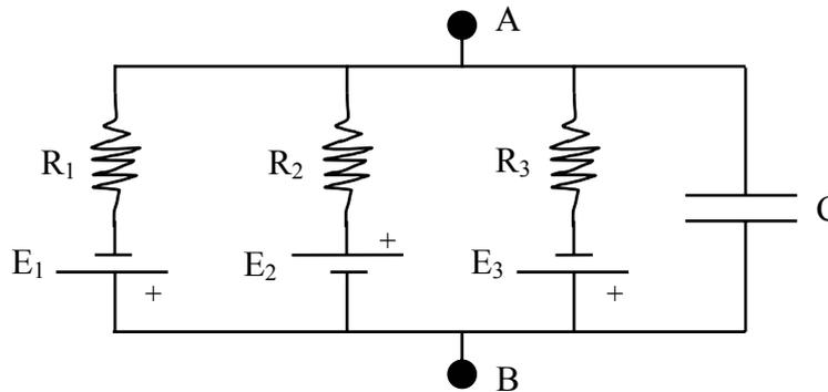
Datos:  $E_1 = 80 \text{ mV}$ ;  $E_2 = 50 \text{ mV}$ ;  $E_3 = 50 \text{ mV}$ ;  $R_1 = 1 \text{ M}\Omega$ ;  $R_2 = 10 \text{ M}\Omega$ ;  $R_3 = 2 \text{ M}\Omega$ ;  $C = 50 \text{ pF}$ . El signo de los "E" está indicado en el circuito.
