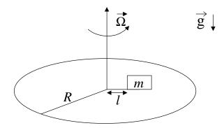
a) Escriba las ecuaciones de Newton para el paquete en un sistema solidario a la plataforma, S', indicando los pares de acción y reacción de las fuerzas que actúan
