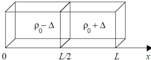
**Problema 17.** Se tiene un tubo dividido en dos regiones separadas por un tabique (ver figura). En una de ellas se tiene una presión  $P = P_0 + \Delta p$  (constante). La otra región está abierta a la atmósfera, teniendo presión  $P_0$ . En  $t = 0$  se remueve el tabique. Hallar  $\delta p(x,t)$ ,  $\psi(x,t)$ ,  $\delta\rho(x,t)$
