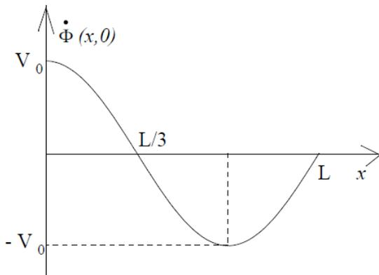
**Problema 12.** Se tiene una cuerda de longitud  $L$ , siendo  $T_o$  su tensión y  $\rho_o$  su densidad lineal, con ambos extremos libres. En  $t=0$ , la velocidad de todos los puntos de la cuerda es nula, y la deformación es la que se muestra en la figura.
