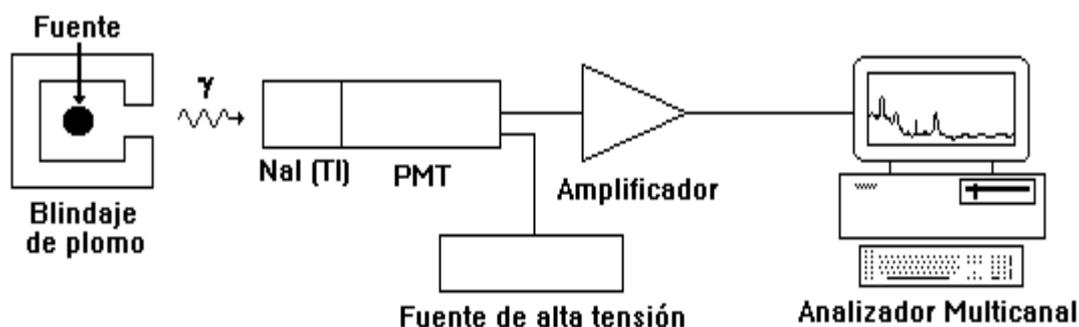
**Figura 1:** Esquema del dispositivo experimental para la obtención de espectros gama de una fuente.
